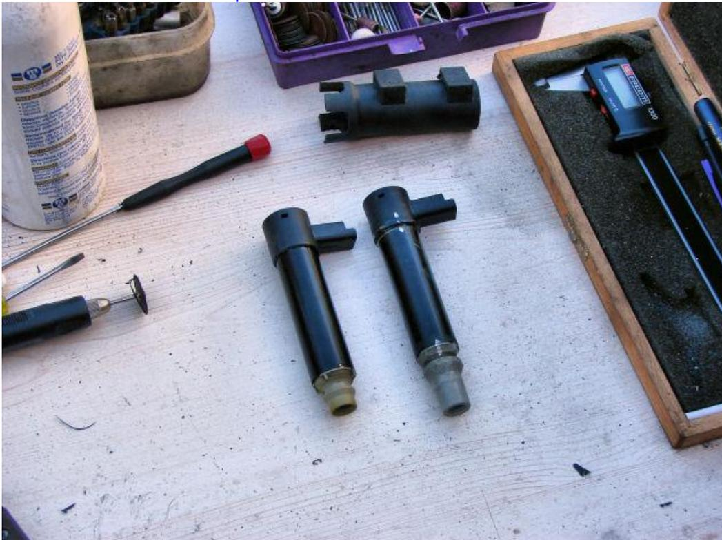
S' assurer que la tête du rivet s' adapte bien à l' intérieur de la bobine, éventuellement réduire le diamètre de la tête du rivet à 9.5 mm.
