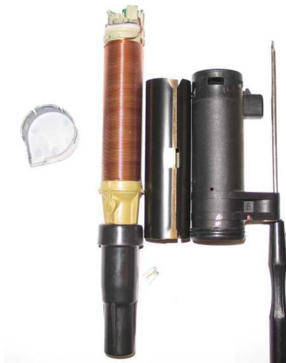
Même les bobinages made in china sur des petits transfos 12V sont de meilleure qualité Renault et SAGEM prennent vraiment les clients pour des pigeons jamais un tel problème n'a existé avec les bobines uniques qui alimentaient 4 cylindres via un delco. Elles n'étaient pas dans une zone aussi chaude mais devaient être aussi de meilleure qualité.
