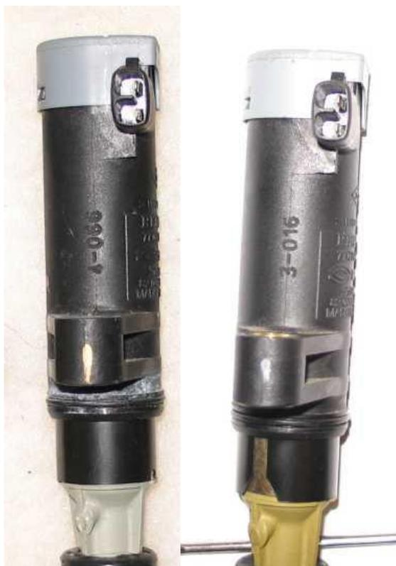
Après avoir remplacé la bobine défectueuse le moteur retourne nickel, le pot pue l'œuf par contre à froid J'ai fais tourner que 30 secondes.
