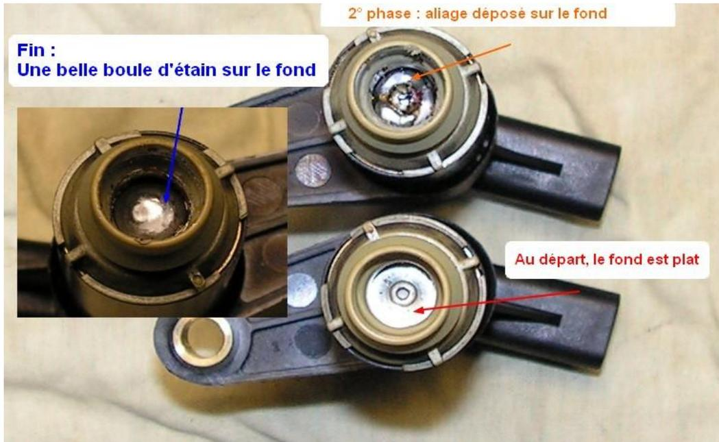
Positionner le rivet étamé dans son logement puis chauffez par la tête du rivet jusqu' à ce que l' étain fonde:
